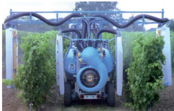
PULVERISATION S21 Tunnel de pulvérisation
