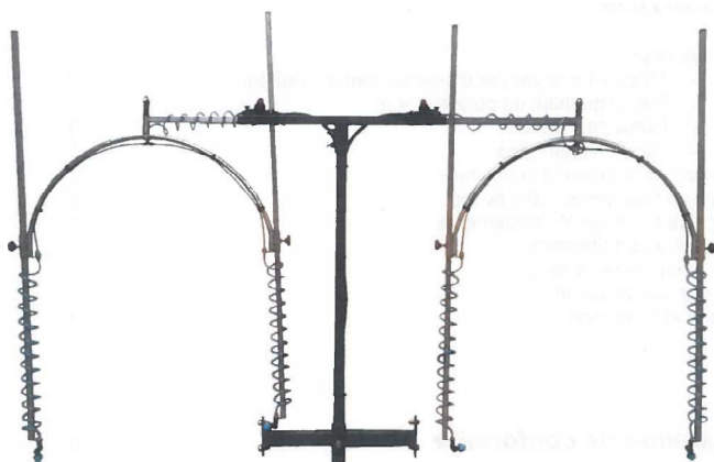
CALVET - rampe premiers traitements
