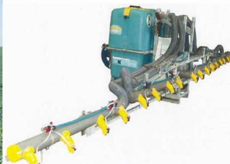
S21 rampe jet porté
